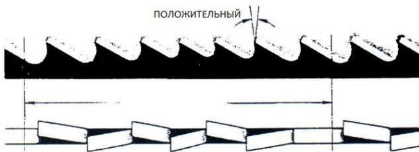
Этот тип пильного полотна больше всего подходит для распила профилей и больших труб с толстыми стенками, а также цельных прутков максимально допустимых для станка размеров. Возможные величины шагов: 3-4/4-6.
