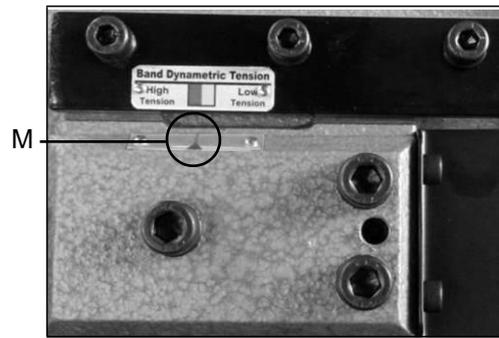
Регулировка натяжения полотна без использования датчика контроля натяжения (H):
