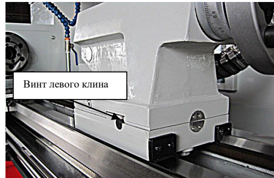
Рис. 92. Один из двух винтов клина задней бабки.
