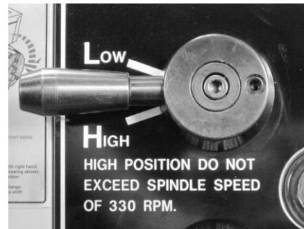
Рис. 17. Рукоятка выбора частоты коробки скоростей.
