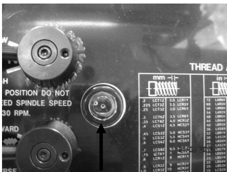
Рис.23. Смотровое окно масляного насоса.
