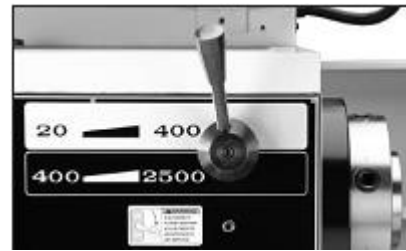
Рис.16. Рукоятка переключения диапазонов передней бабки.
