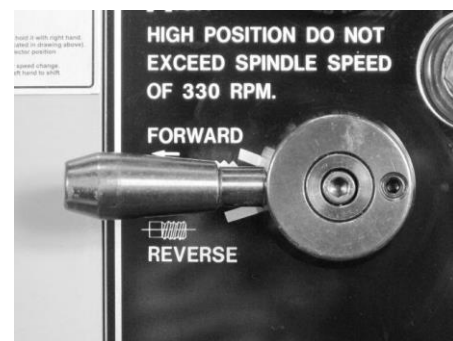
Рис.18 Рукоятка выбора направления подачи Вперед (Forward)/Назад (Reverse)
