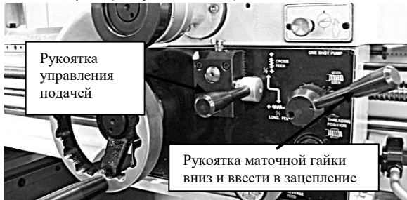
Рис. 54. Установка элементов управления кареткой для нарезания резьбы
