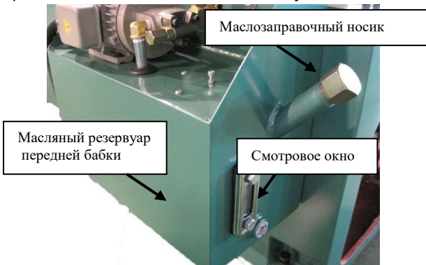
Рис. 70 Масляный резервуар передней бабки и его элементы.
