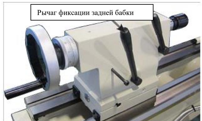
Рис. 9. Рычаг фиксации задней бабки.
