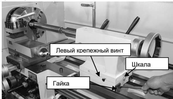
Рис. 35. Регулировка смещения задней бабки.
