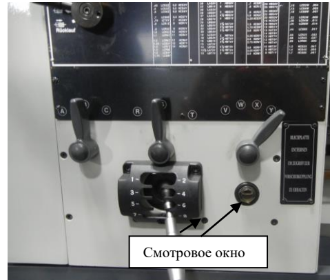
Рис. 74. Расположение смотрового окна коробки скоростей.
