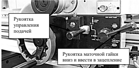
Рис. 54. Установка элементов управления кареткой для нарезания резьбы
