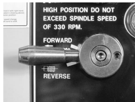
Рис. 18. Рукоятка выбора направления подачи Вперед (Forward)/Назад (Reverse)
