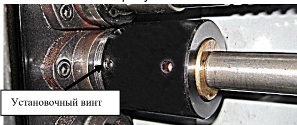
Рис. 95. Удаление установочного винта из ободка муфты.
