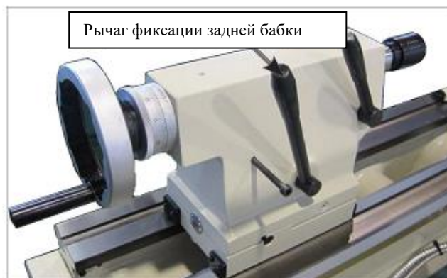
Рис. 9. Рычаг фиксации задней бабки.
