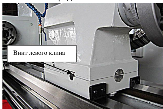
Рис. 92. Один из двух винтов клина задней бабки.
