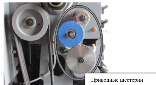
Рис. 83. Расположение приводных шестерен, которым требуется смазка.
