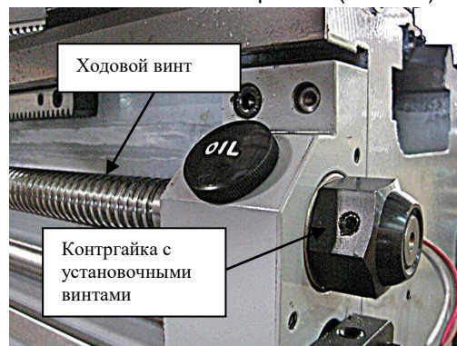
Рис. 88. Регулировка люфта ходового винта
