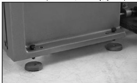
Рис.13. Выравнивание ножек и винтов Для выравнивания станка используйте точный уровень, удостоверьтесь, что направляющие станины выровнены слева-направо и от передней части к задней. Выравниванию оборудования помогают высоко-
