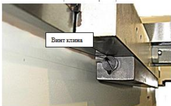
Рис. 90. Один из двух винтов заднего клина салазок.
