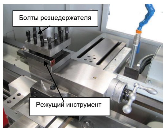
Рис. 42. 4-х позиционный резцедержатель.
