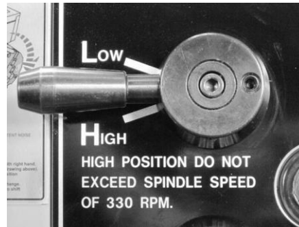
Рис. 17. Рукоятка выбора частоты коробки скоростей.
