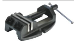
Изготавливаются из серого чугуна. Предназначены для точных работ, имеют шлифованное основание и направляющие. Горизонтальные и вертикальные V-образные канавки на неподвижной губке позволяют надёжно удерживать цилиндрические заготовки
