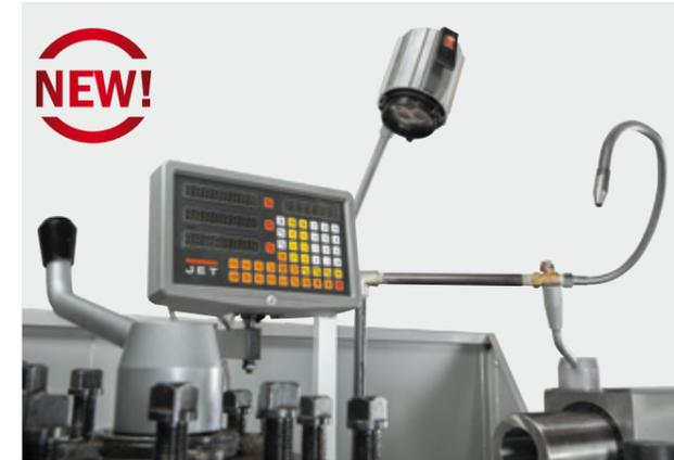
УЦИ - устройства цифровой индикации - предназначены для оснащения универсальных металлорежущих станков (токарных, фрезерных, сверлильных и т.п.) с целью повышения производительности работы, повышения точностных характеристик и выполнения сложных операций.
