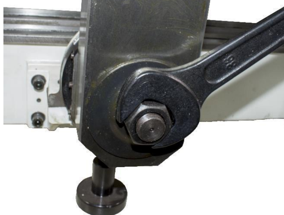
Рис. 35 Гайка фрезерной приставки Для изменения угла наклона стойки необходимо, надёжно удерживая фрезерную приставку, отпустить гайку сзади, ключом из набора. После установки нужного угла хорошо затянуть гайку.
