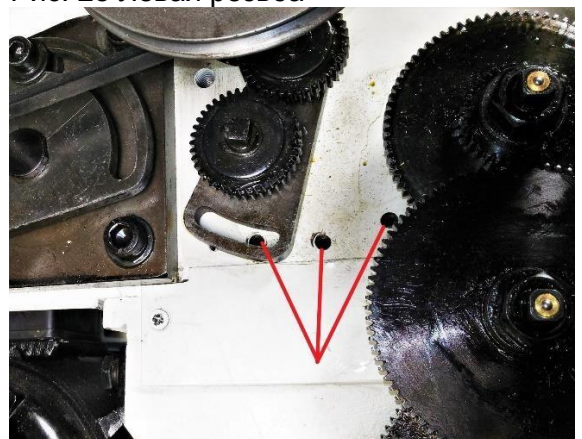
Рис. 29 Отверстия фиксирующего винта Когда прямая шестерня и шестерня D в зацеплении, работает режим прямой резьбы, см. Рисунок 27 При зацеплении паразитной шестерни и
