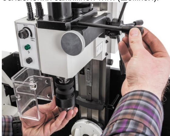
Рис. 31 Для блокировки шпинделя используйте блокировочный штифт (рисунок 31) Медным или деревянным молотком, через смягчающую прокладку, простучите конец зажимной тяги как показано на рисунке 32. Патрон ослабится.
