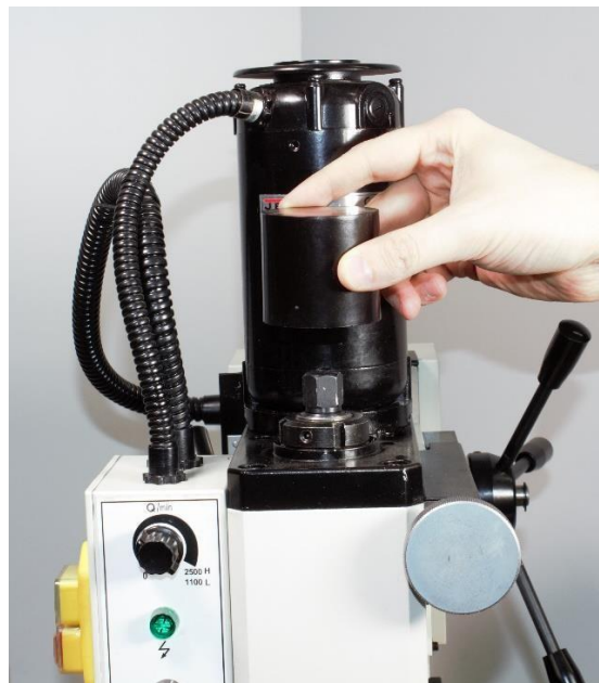
Рис. 30 Используйте гаечный ключ на 19 мм для ослабления зажимной тяги (шомпол).
